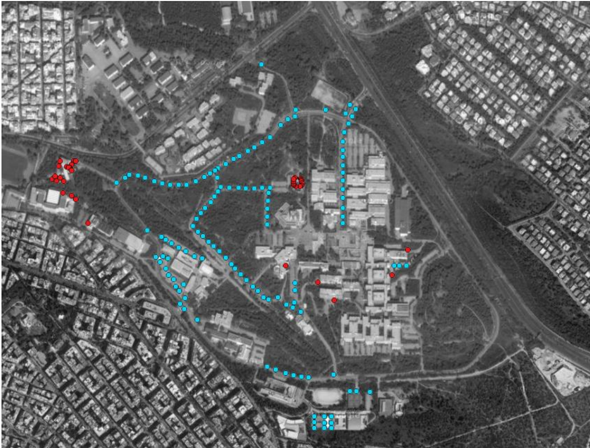
Εικόνα 4 Φωτιστικά τύπου βραχίονα (με κόκκινο χρώμα), εγκατεστημένα επί κτιρίων, σε κορυφές ή επίτοιχα, τα οποία αντικαθίστανται με προβολείς LED και όχι με τα αντίστοιχα της ομάδας.
